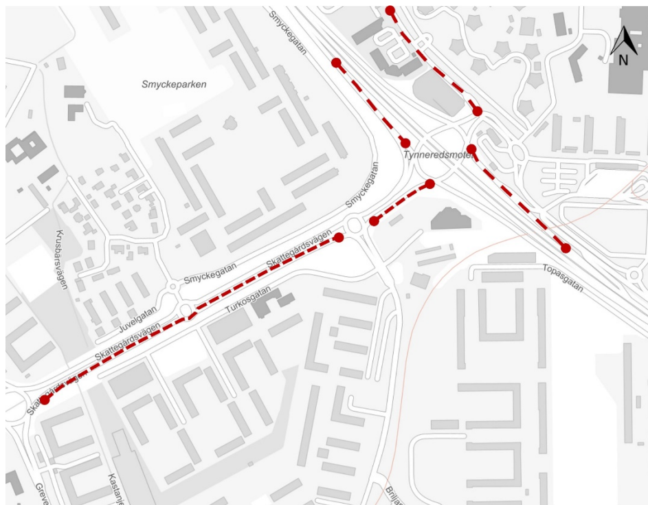
Figur 18 Punkter i modellen för Skattegårdsvägen där kölängder har analyserats. Sträckningen på bilden avser avståndet bakåt som anses kritiskt eller betydande.
