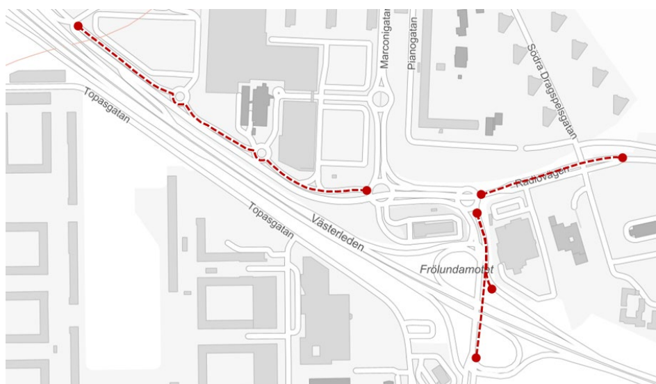
Figur 14 Punkter i modellen för Frölunda Torg där kölängder har analyserats. Sträckningen på bilden avser avståndet bakåt som anses kritiskt.
